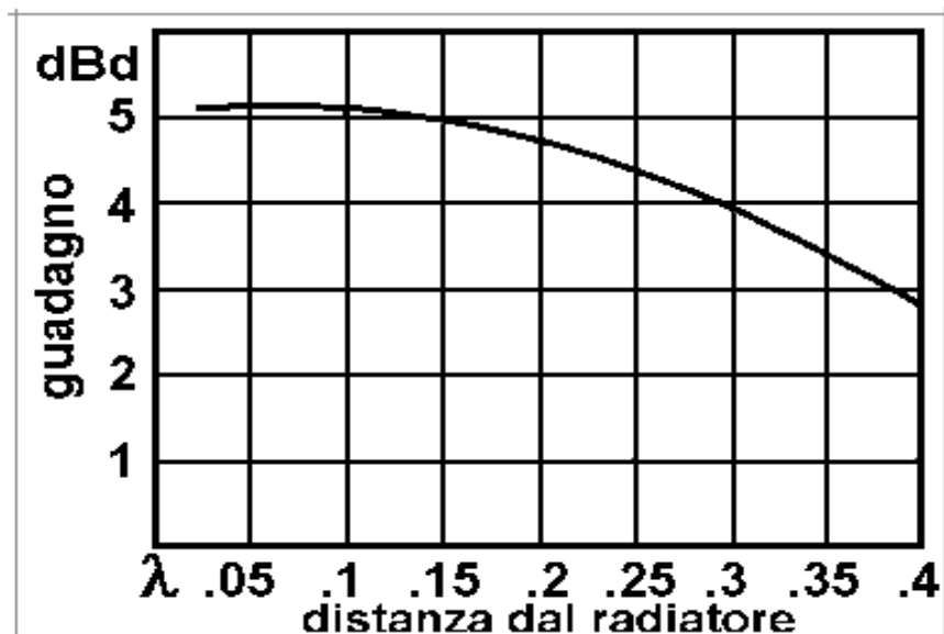
Grafico della spaziatura per un guadagno in avanti quando l'elemento parassita è un riflettore.
