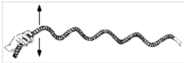
Moto oscillatorio di una fune eccitata verticalmente, lungo la quale si propagano onde lineari
