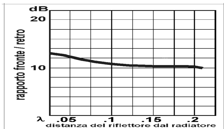
Grafico per conoscere il rapporto A/R quando l'elemento parassita è un riflettore.
