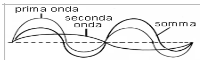
Quando si sovrappongono due onde, quella risultante è la somma delle due, in ogni istante e in ogni punto. Generalmente, l'onda che si ottiene non è più sinusoidale.
